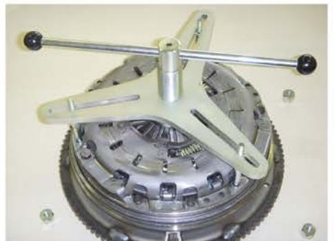
15. Enlever les écrous et retirer la traverse de pression.
