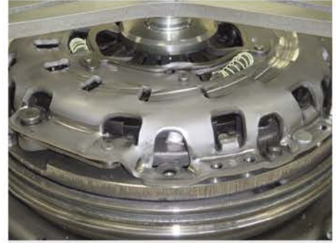
12. ✓ Correct : La cloche d'embrayage est bien en appui.
