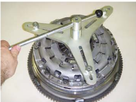
14. Desserrer complètement la traverse de pression – le ressort de la cloche d'embrayage va se détendre.
