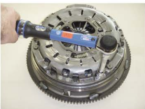
17. Visser manuellement les vis de fixation restantes dans les taraudages du volant moteur et serrer toutes les vis au couple de serrage préconisé par le constructeur.
