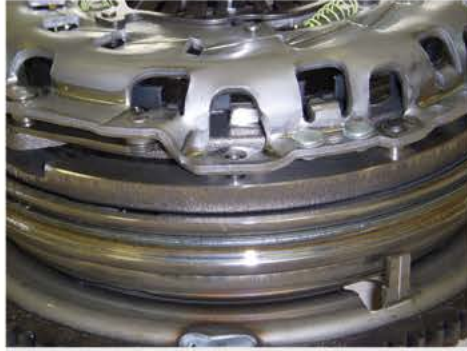
11. X Attention: La cloche d'embrayage n'est pas en appui.
