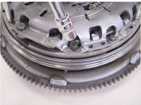
13. Visser les vis de fixation des emplacements libre de la cloche d'embrayage.
